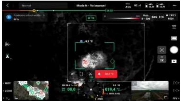
Les fumerolles sont observées quotidiennement par des drones pour évaluer l'activité du feu sous la terre. Ici, le point chaud culmine à 200 degrés. • © France 3 Aquitaine
