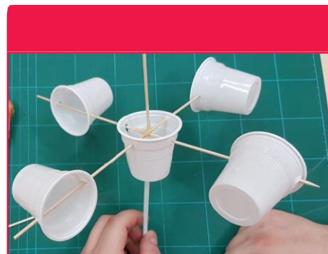
↑ Anemometr k měření rychlosti větru.
