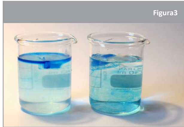
↑ Resultados experimentais: A água colorida proveniente da fusão dos cubos de gelo fica à superfície da água salgada, que é mais densa, no goblet 1(à esquerda)
