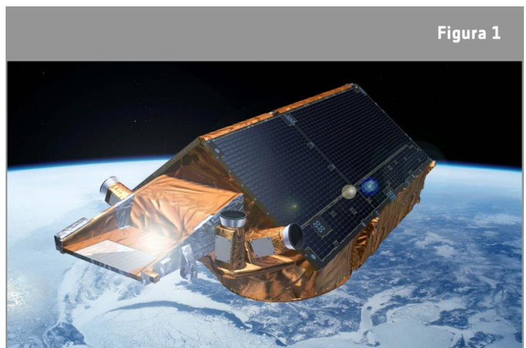
↑ Il satellite Cryosat dell'ESA ha come scopo la misura dello spessore dei ghiacci marini polari e il monitoraggio dei cambiamenti nei blocchi di ghiaccio che ricoprono la Groenlandia e l'Antartide.
