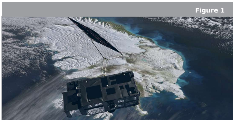
↑ Le satellite européen Sentinel-3 transporte une série d'instruments de pointe, dont un radiomètre infrarouge qui fournit des cartes mondiales de la température de la surface de la mer pour la surveillance du changement climatique, des océans et des prévisions météorologiques.
