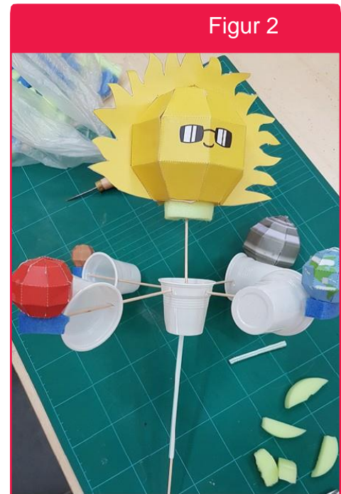
↑ Vindmåler til måling af vindhastighed.
